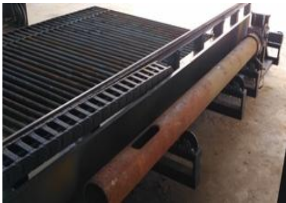
Труборезная приставка, зажимной патрон 200мм.
